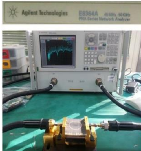
Agilent E8364A PNA Network Analyzer 및 Universal Test fixture 3830K(ANRITSU社)가 Ring resonator Test에 사용
